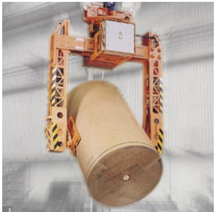
3 Obrotowy chwytak do bel papieru, kompaktowa budowa z możliwością obrotu w poziomie i optymalną wagą własną
