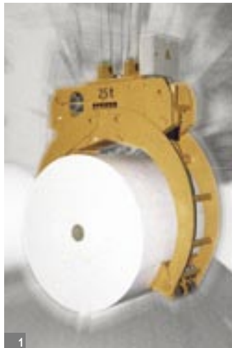
1 Chwytki do bel papieru 2,5 t, zamykanie za pomocą dwóch ramion
